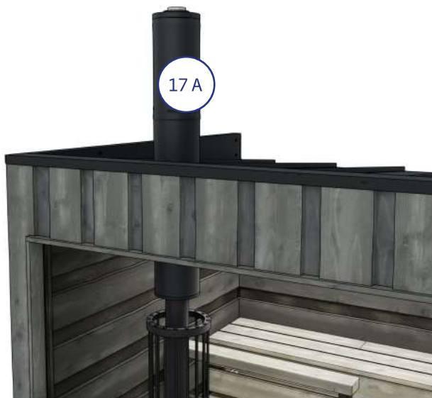
11. Pujota teräspiippu ( 17 A ) eristevillan ja katon lävitse. Laske teräspiippu savupeltijakson ( 15 ) päälle.
