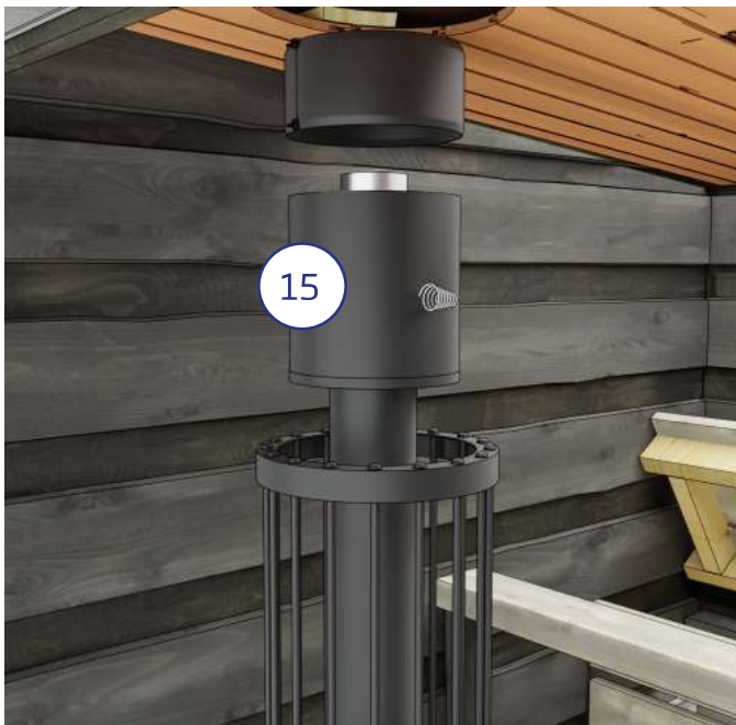
9. Asettele savupeltijakso ( 15 ) savuputken ( 16 B.) päähän.
