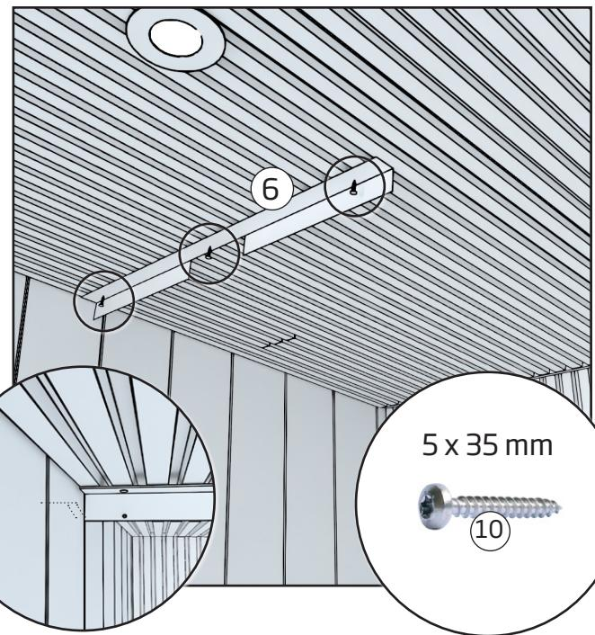
Fissare la piastra di collegamento tra la doccia per esterno e il tetto al soffitto della terrazza, posizionandola a 830 mm dalla parete posteriore e a 3-5 mm dalla parete laterale.
