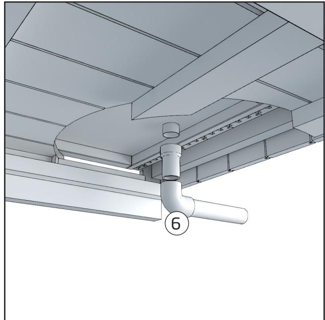
De basis heeft een voorgemonteerde afvalwaterafvoer van 50 mm. Bij de installatie van het Kirami FinVision® -terras verbindt u de delen van de pijp in de volgorde zoals aangeduid op de afbeelding om de afvoer van de buitendouche naar de achterkant van de module te leiden.
