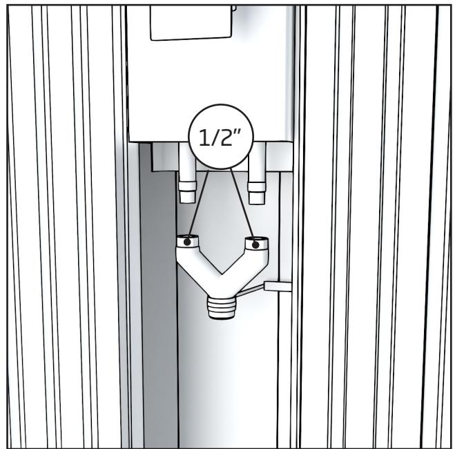
1. Verwijder de messing pijpsplitter door de moeren tegen de klok in te draaien en de beugel los te maken van de muur.
