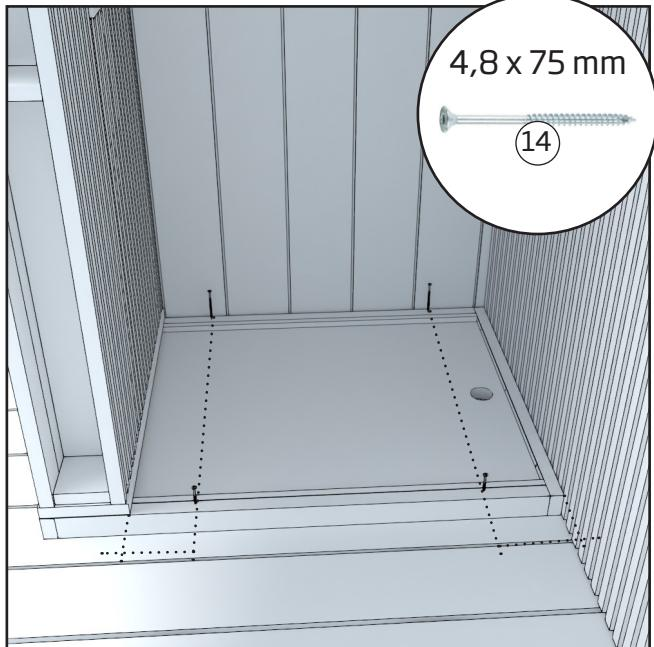
Lyft bort underlagets galler och montera fast underlaget i terrassdäcket med skruvar. Avsluta med att lägga tillbaka underlagets galler.
