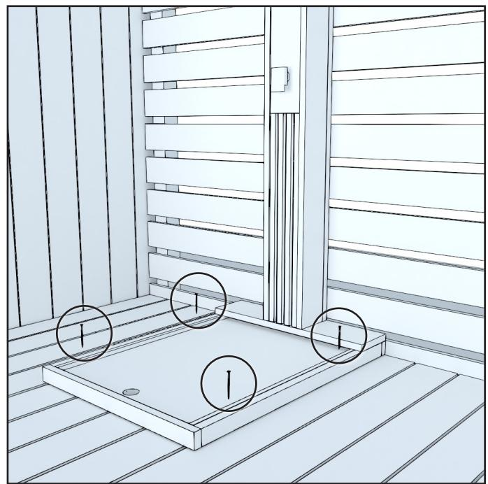
Pilarimallin ulkosuihkuissa, kiinnitä ulkosuihku alustasta alla olevaan materiaaliin neljällä ruuvilla.
