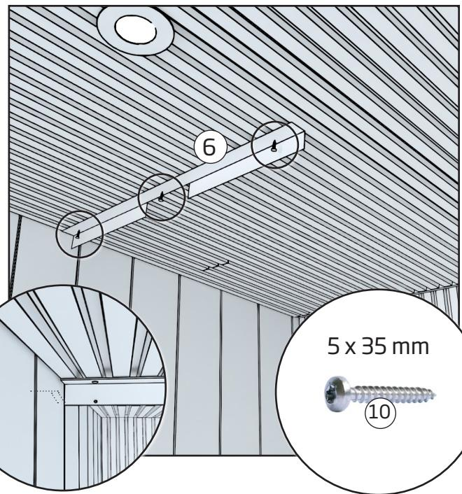
Befestigen Sie die Verbindungsplatte zwischen der Außendusche und dem Dach an der Terrassedecke und positionieren Sie sie 830 mm von der Rückwand und 3-5 mm von der Seitenwand entfernt.
