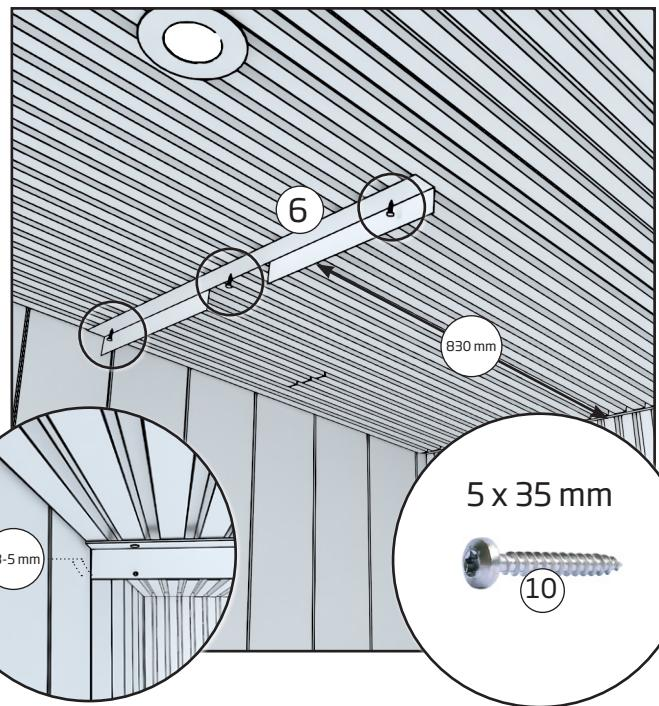
Kiinnitä ulkosuihkun ja katon liitospelti terassin sisäkattoon 830 mm pähän takaseinästä ja 3-5 mm pähän sivuseinästä
