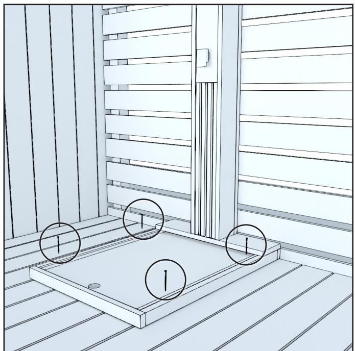
I pelarmodellens utedusch ska du montera uteduschenhetens underlag i materialet under med fyra skruvar.
