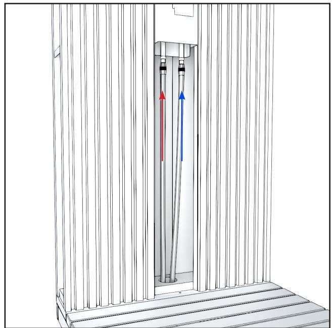
3. Führen Sie den Gartenschlauch/das Rohr in die Wand durch das Loch, das Sie in die Terrasse gebohrt haben, und durch das Loch unter der Außendusche. Schließen Sie Warmwasser auf der linken Seite und Kaltwasser auf der rechten Seite an.
