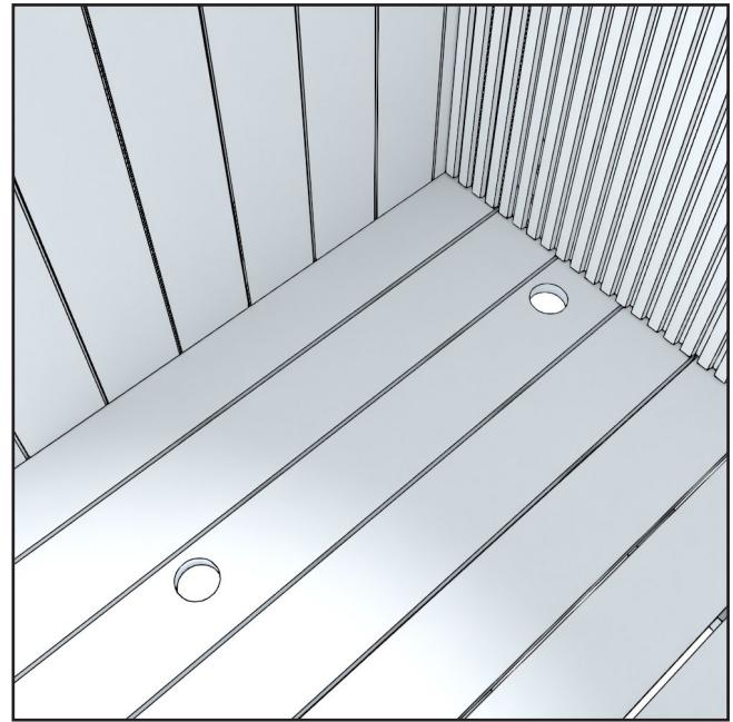
Wenn die Kirami FinVision® -Außendusche Misty nachträglich bestellt wird, müssen im Terrassenmodul Löcher für den Wasserzu- und -ablauf gebohrt werden. Der Durchmesser des in die Terrasse zu bohrenden Lochs beträgt mindestens 73 mm.
