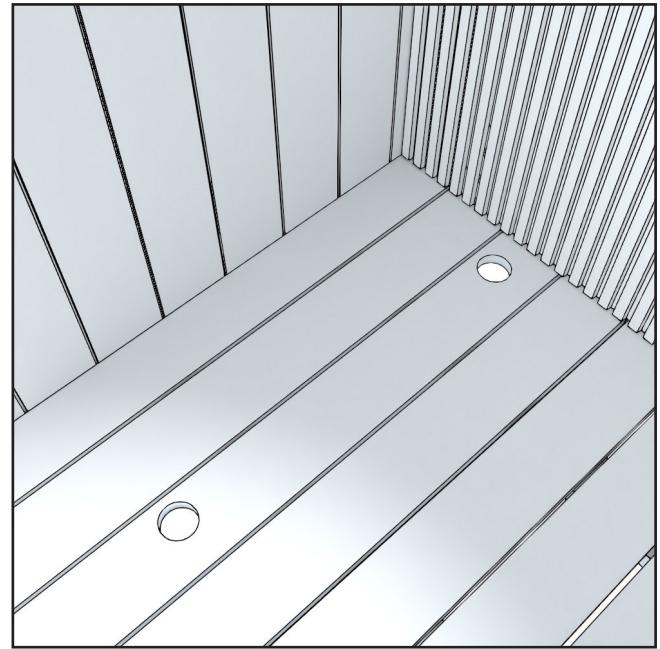
När Kirami FinVision® -utedusch Misty beställs i efterhand ska hålen för vattenintag och -avlopp borras i terrassmodulen. Diametern på hålet som ska borras i terrassen är minst 73 mm.
