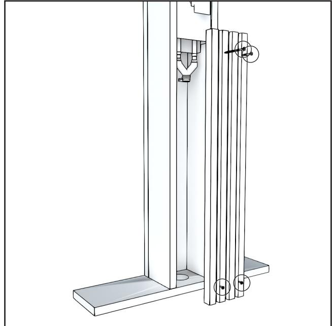
1. Kopplingarna för tillvatten finns under de främre panelerna. Ta loss panelerna.
