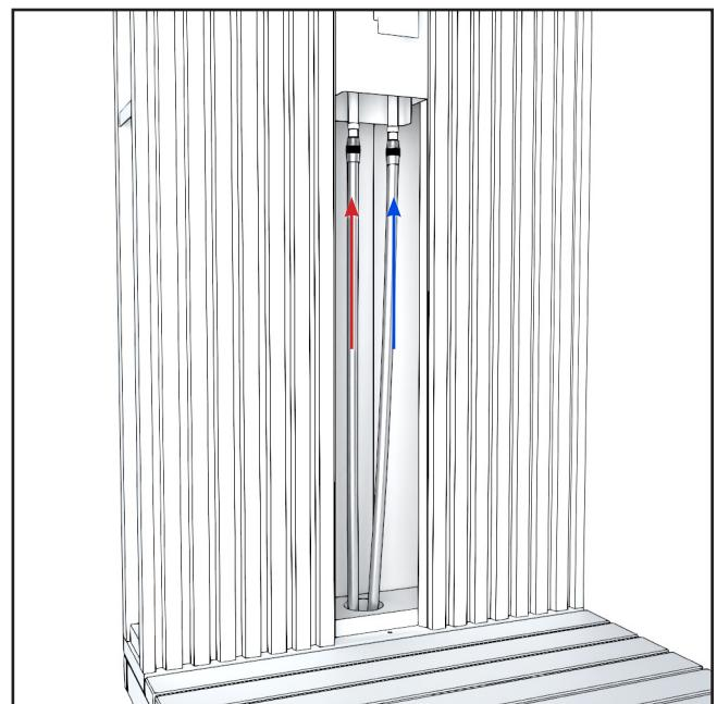
2. Trä trädgårdsslangen/rören genom väggens hål som du borrat i terrassen, och hålet under uteduschen. Fäst varmt vatten på vänster sida och kallt på höger sida.
