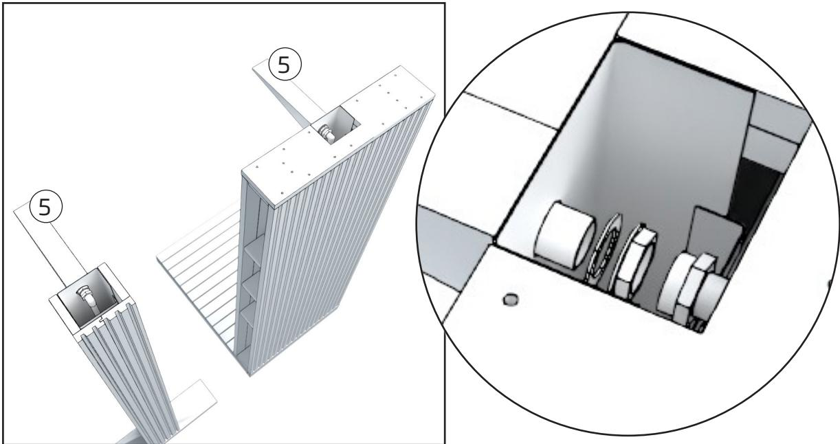
Commencez par fixer le pommeau de douche à la plaque en acier inoxydable à l'aide d'un écrou en laiton ; notez qu'une rondelle doit être placée entre la plaque en acier inoxydable et l'écrou en laiton. Retirez le ruban adhésif du coude à l'intérieur de la douche avant de le raccorder au pommeau de douche.
