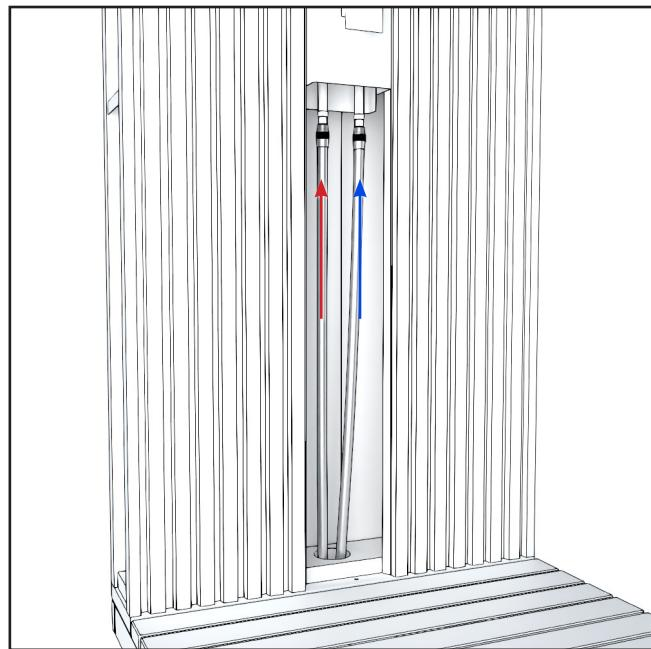
2. Faites passer les tuyaux d'arrosage dans le mur par le trou que vous avez percé dans la terrasse et par le trou situé sous la douche de jardin. Raccordez l'eau chaude au côté gauche et l'eau froide au côté droit.
