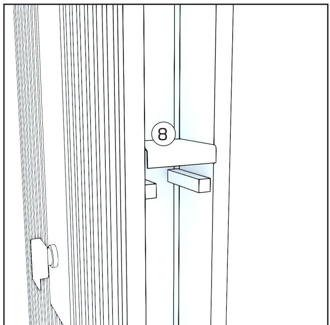
Bei Außenduschen mit einer Duschwand befinden sich an den Seiten Halterungen für Ablagen. Setzen Sie die Ablagen auf die Halterungen.
