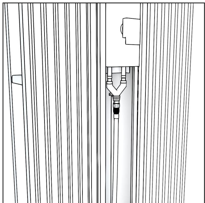
2. Führen Sie den Gartenschlauch durch das Loch an der Unterseite der Außendusche in die Wand und schließen Sie ihn dann an die Dusche an.
