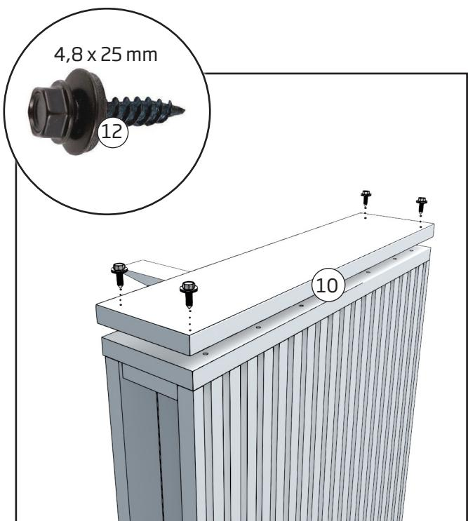
Säulenmodell: Befestigen Sie das Ende mit vier Schrauben an der Außendusche.
