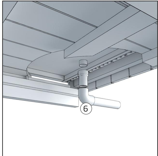
Underlaget har ett färdigt 50 mm stort avloppsutlopp för tvättvattnet. Vid montering av Kirami FinVision® -terrassen, ska du ansluta rördelarna i den ordning som anges på bilden, varvid uteduschens vattenavledning hamnar bakom modulen.
