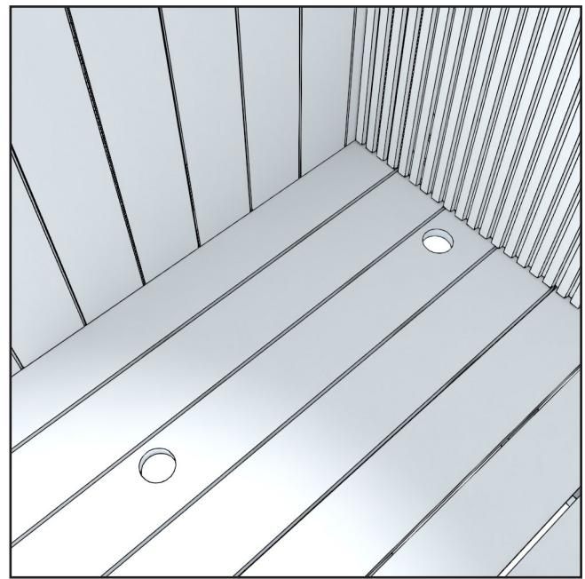
Kun Kirami FinVision® -ulkosuihku Misty tilataan jälkikäteen, täytyy terassimoduuliin porata reiät veden tulo- ja poistovedelle. Terassiin porattavan reiän halkaisija on vähintään 73 mm.
