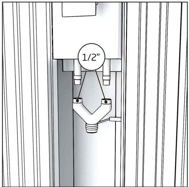
1. Entfernen Sie den Rohrspalter aus Messing, indem Sie die Muttern gegen den Uhrzeigersinn drehen und die Halterung von der Wand lösen.
