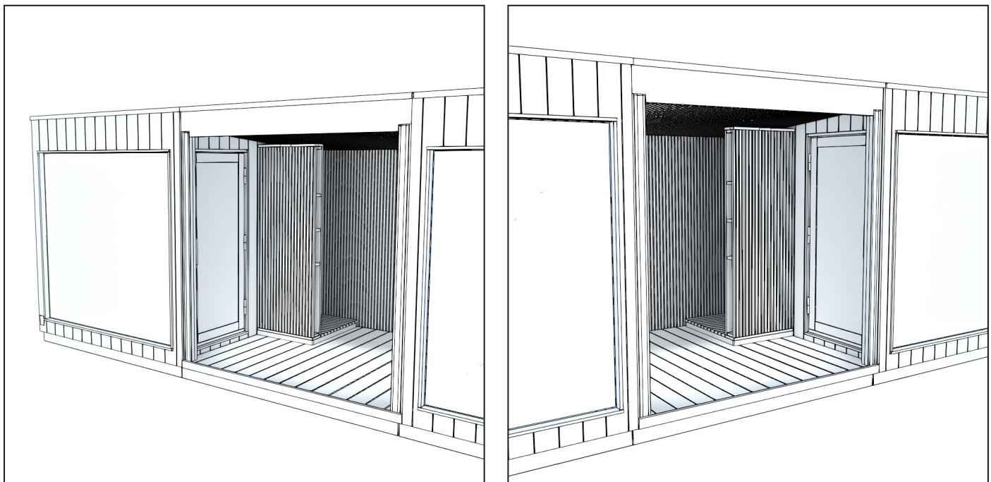
Die Kirami FinVision® Misty Außendusche (Terrassenmodell) wird immer auf der Kirami FinVision® Terrasse montiert, entweder am linken oder rechten Rand, so dass eine Seite der Außen dusche an einem anderen Modul anliegt.
