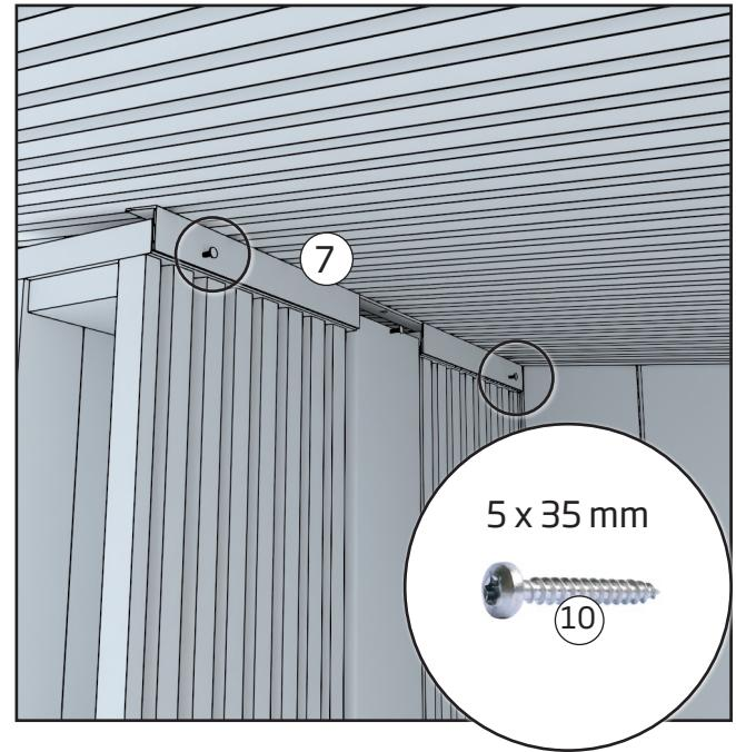
Placera uteduschen mot skarvplåten och terrassens bakvägg. Montera skarvplåten i uteduschen med skruvar.
