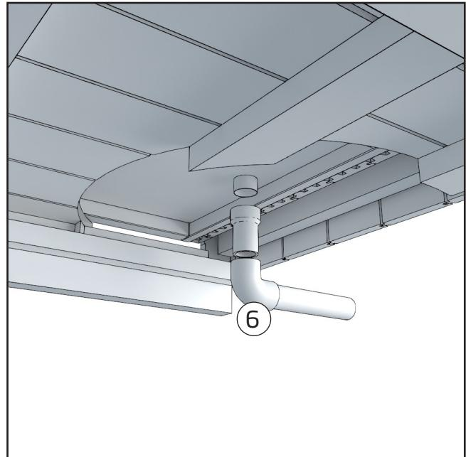
Der Sockel verfügt über einen vorgefertigten 50-mm-Abfluss für Abwasser. Bei der Montage der Kirami FinVision® Terrasse verbinden Sie die Rohrteile in der im Bild gezeigten Reihenfolge, um den Abfluss der Außendusche zur Rückseite des Moduls zu führen.
