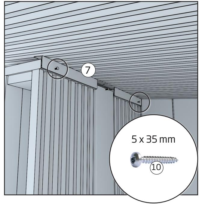
Posizionare la doccia per esterno contro la piastra di collegamento e la parete posteriore della terrazza. Fissare la piastra di collegamento alla doccia con le viti.
