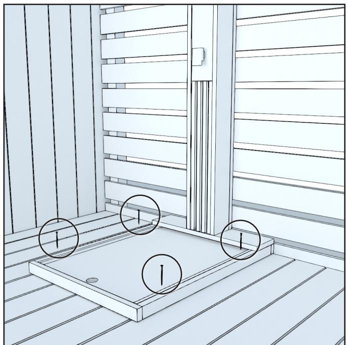
Per le docce a colonna, fissare la base della doccia per esterno alla parte sottostante con quattro viti.
