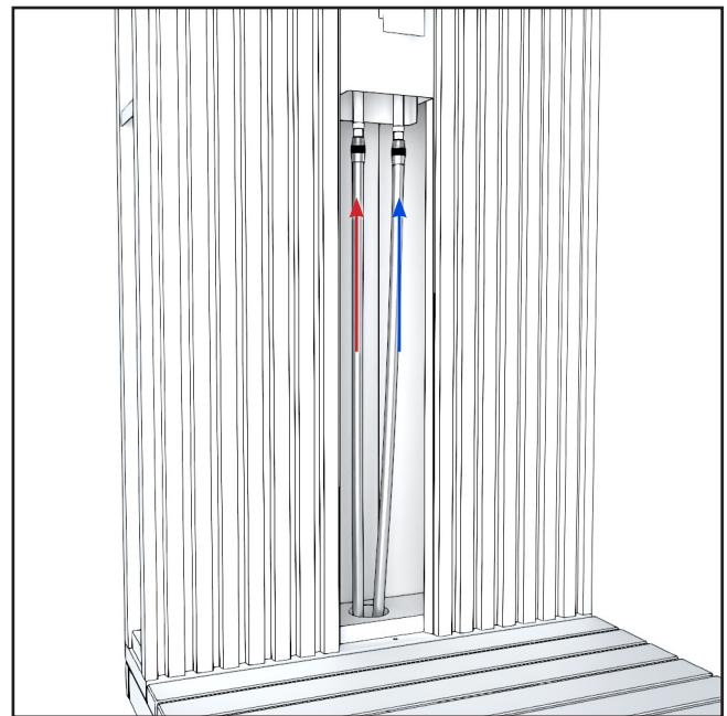
2. Pujota letkut/putket terassiin poraamasi reiän ja ulkosuihkun alhaalla olevan reiän kautta suihkuseinälle. Kytke lämmmin vesi vasemmalle ja kylmä oikealle.
