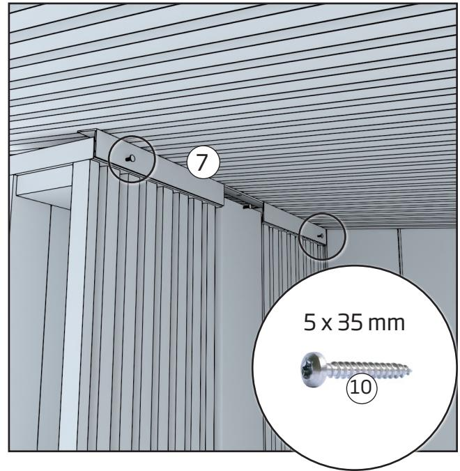
Positionieren Sie die Außendusche gegen die Verbindungsplatte und die Rückwand der Terrasse. Befestigen Sie die Verbindungsplatte mit Schrauben an der Außendusche.
