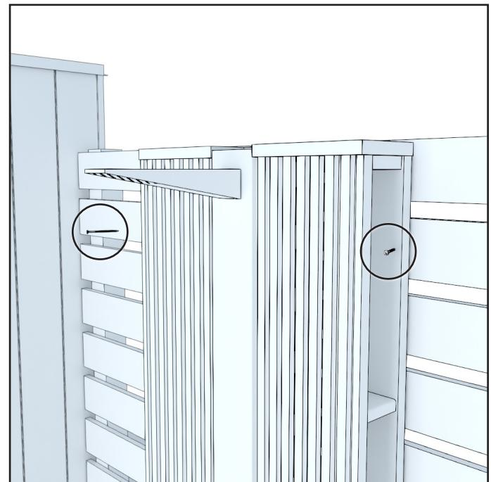
Seinällä varustellussa ulkosuihkussa, kiinnitä ensin alustasta alla olevaan materiaaliin neljällä ruuvilla. Kiinnitä seinän yläosasta vastakkaiseen materiaaliin molemmilta sivulta kahdella ruuvilla.
