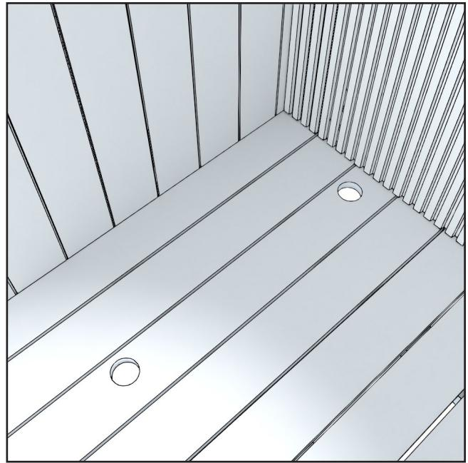
Si la douche de jardin Kirami FinVision® Misty est commandée ultérieurement, des trous doivent être percés dans le module terrasse pour l'arrivée et l'évacuation de l'eau. Le diamètre du trou à percer dans la terrasse doit être d'au moins 73 mm.
