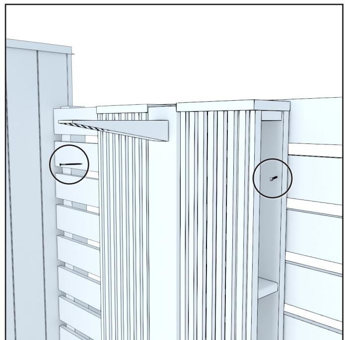
I den väggmonterade uteduschen ska du först montera underlaget i materialet under med fyra skruvar. Fäst väggens överdel i det motstående materialet på båda sidorna med två skruvar.
