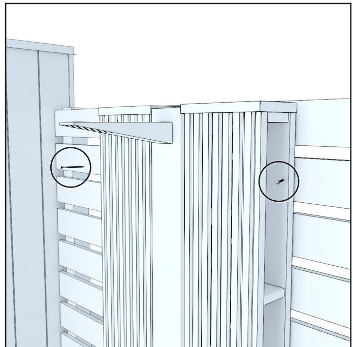
Per le docce con parete, fissare innanzitutto la base alla parte sottostante con quattro viti. Quindi, fissare la parte superiore della parete al materiale opposto su due lati con delle viti.
