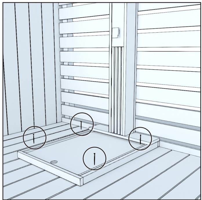
Bei Säulenduschen befestigen Sie die Basis der Außendusche mit vier Schrauben am Untergrund.
