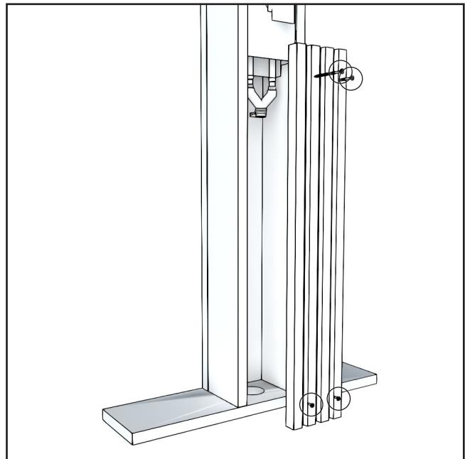
1. Die Wasserzulaufanschlüsse befinden sich unter den Frontpaneelen. Entfernen Sie die Paneele.
