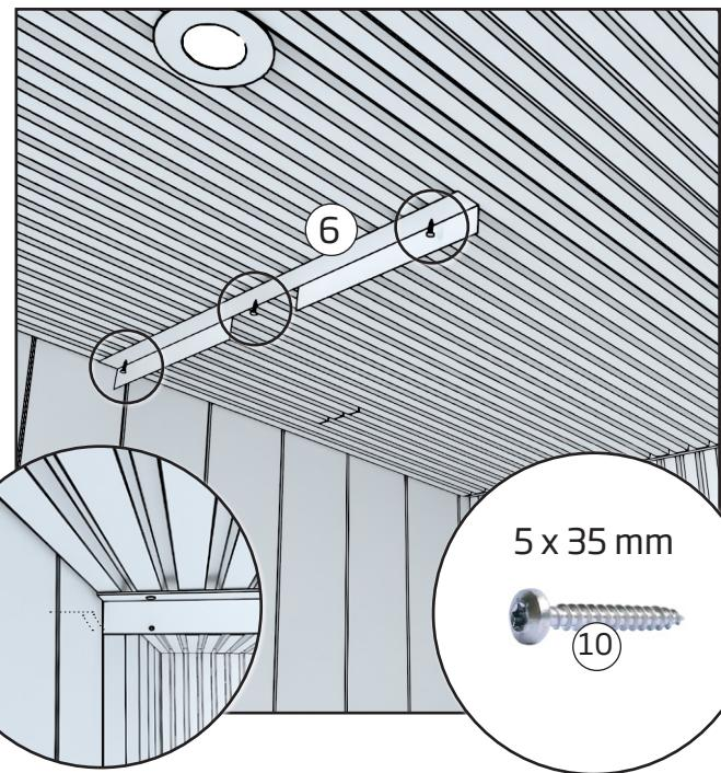
Fixez la plaque de raccordement entre la douche de jardin et le toit au plafond de la terrasse, en la plaçant à 830 mm du mur du fond et à 3-5 mm du mur latéral.
