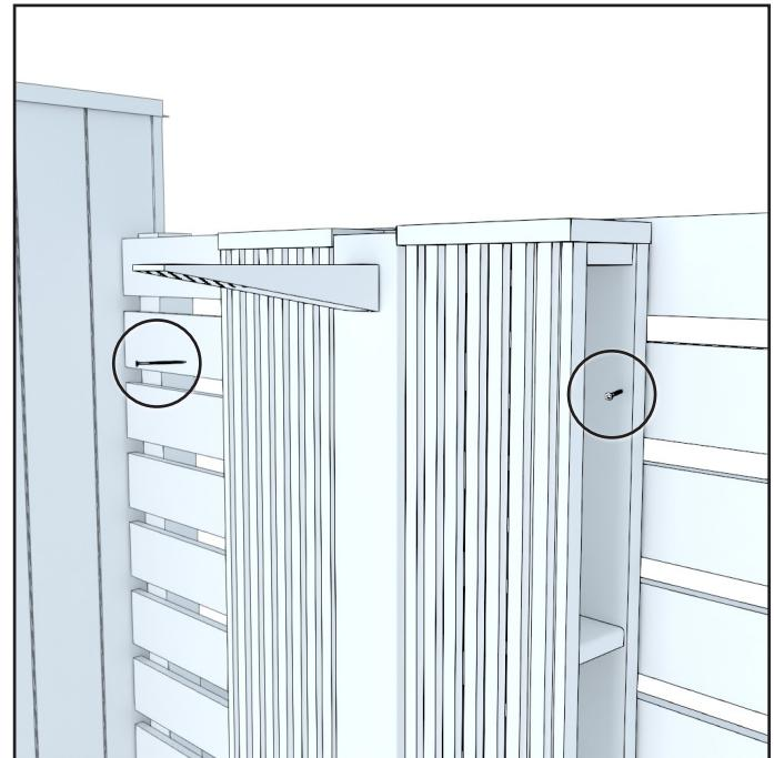
Bei einer Außendusche mit Wand befestigen Sie zunächst die Basis mit vier Schrauben an dem darunter liegenden Material. Befestigen Sie dann den oberen Teil der Wand auf beiden Seiten mit Schrauben an dem angrenzenden Material.
