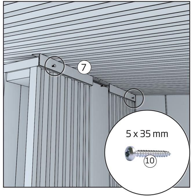
Asettele ulkosuihku päin liitospeltiä ja terassin takaseinää. Kiinnitä liitospelti ulkosuihkuun ruuveilla.
