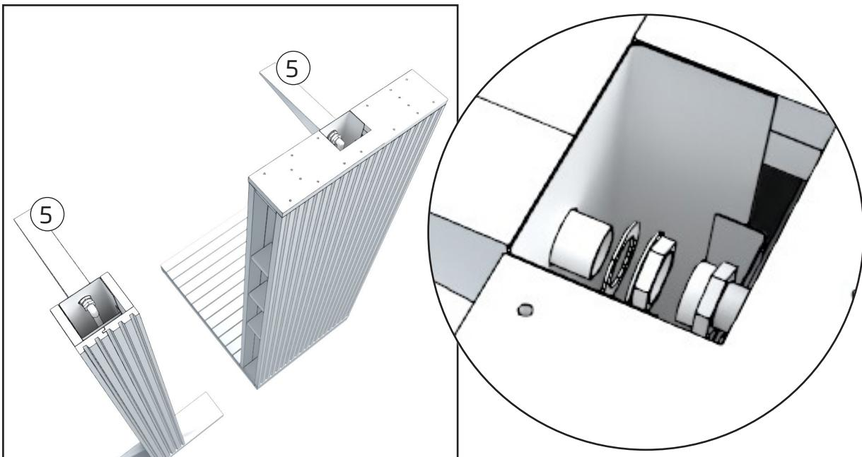
Liitä suihkupää ensin ruostumattomasta teräksestä valmistettuun levyyn messinkimutterilla, huomaa että ruostumattoman levyn ja messinkimutterin väliin tulee aluslevy. Poista teippi suihkun sisällä olevan kulmasta ja liitä se suihkupähän.
