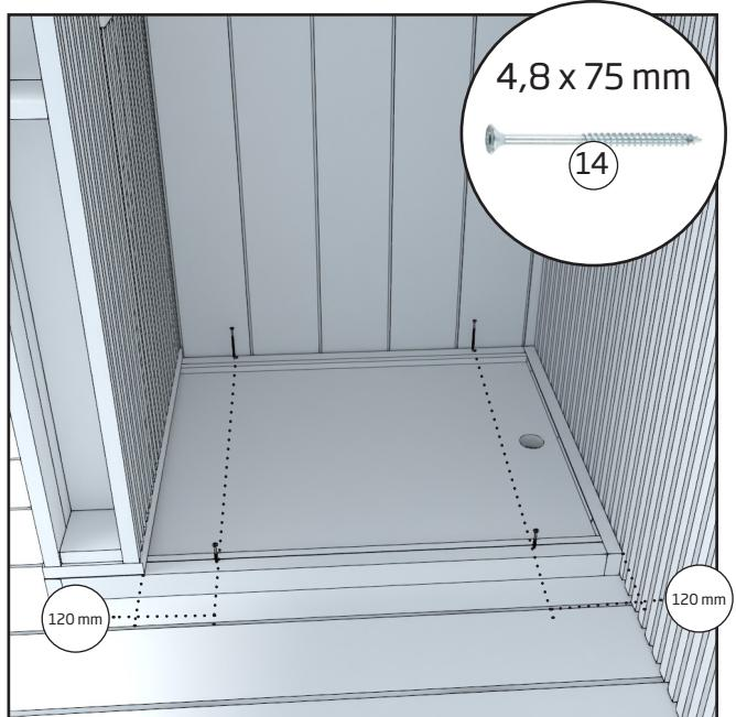
Nosta alustan rililä pois ja kiinnitä ruuveilla alusta terassin kanteen. Lopuksi laita alustan rililä takaisin paikoilleen.
