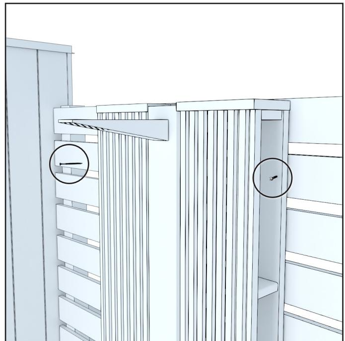
Voor een buitendouche met een wand maakt u de voet eerst met vier schroeven vast aan het onderliggende materiaal. Vervolgens bevestigt u de bovenkant van de muur aan beide zijden met schroeven vast aan het tegenoverliggende materiaal.
