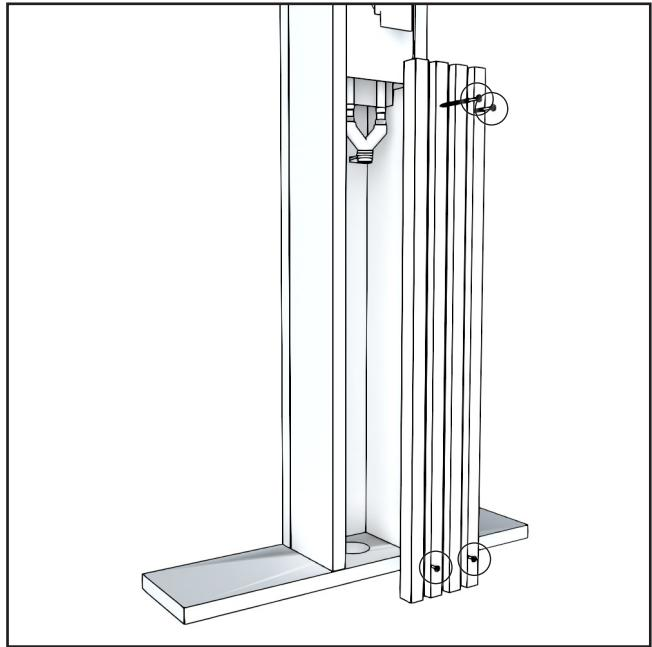
1. De waterinlaataansluitingen bevinden zich onder de voorpanelen. Verwijder de panelen.
