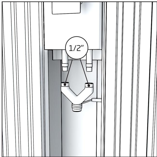
1. Retirez le séparateur de tuyaux en laiton en tournant les écrous dans le sens inverse des aiguilles d'une montre et en détachant le support du mur.
