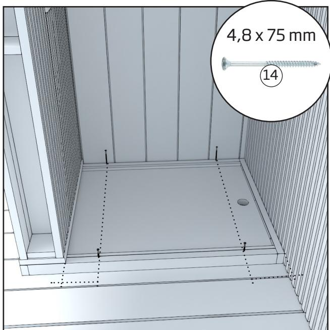
Heben Sie den Rost ab und schrauben Sie den Sockel auf das Terrassendeck. Bringen Sie das Bodengitter wieder an.
