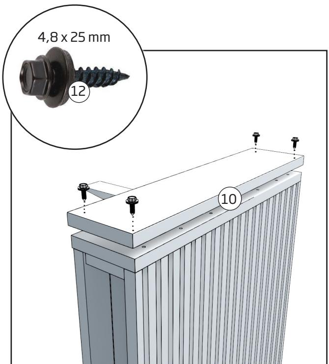
Pelarmodell: Anslut ändan till uteduschen med fyra skruvar.
