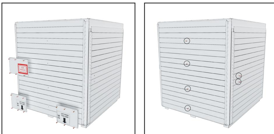
4. Retirez les pancartes de l'emballage. Retirez toutes les vis des planches. Ces vis maintiennent les supports à l'intérieur des planches en place.
