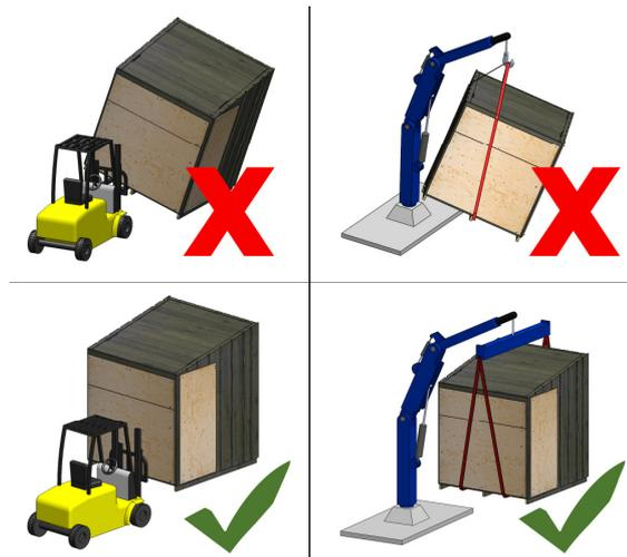
Zum Versetzen der Sauna müssen Hebetücher, die Gabeln eines Gabelstaplers oder ein mit langen Gabeln ausgestatteter Hubwagen so unter die Verpackungspalette geschoben werden, dass die Palette die Elemente während des gesamten Hubvorgangs möglichst gut abstützt, die Sauna gerade und die Tragfähigkeit gleichmäßig verteilt bleibt. Aus den Beispielabbildungen ist zu entnehmen, wie die Sauna mit einem Gabelstapler oder mit Hebetüchern an ihren Platz zu heben ist.
