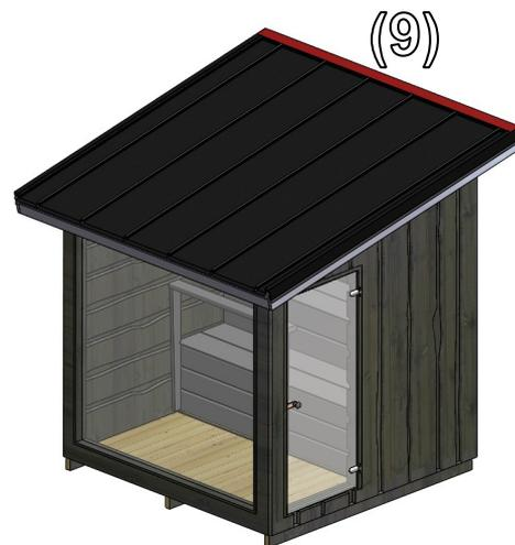
12. Befestigen Sie zuletzt die **Abschlussleiste (9)** an der Saunarückseite mit **Dachblechschauben (12)**.
