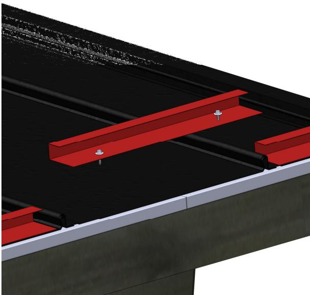
11. Befestigen Sie die Dichtungsleisten (wie im Bild 10) mit **Blechschauben (16)**.
